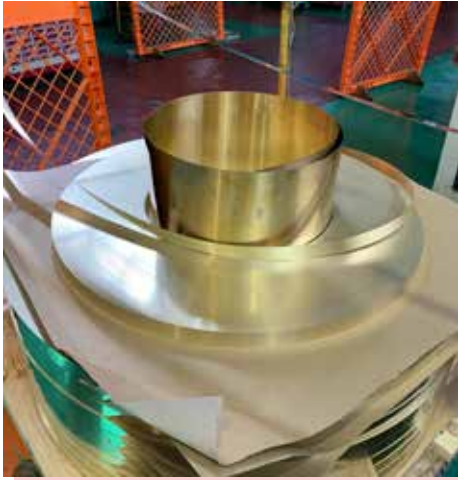
これがホックの真鍮材料です！帯状に巻かれた原材料を機械で少しずつ形を変える加工をして複雑なホック形状を作っていきます。
